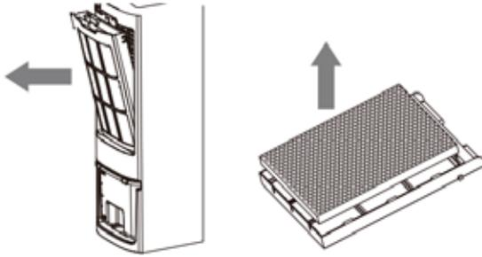
**Huomautus:** Jos laitetta käytetään pitkään, suodatusverkko menee tukkoon pölystä ja liasta, Tämä vaikuttaa suuresti laitteen suoritusasteeseen. Suosittelemme puhdistamaan suodatusverkon säännöllisesti.
